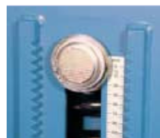
Pino de bloqueio com grampos circulares
