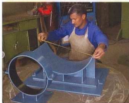
SUPORTES DE TUBULAÇÃO DE BAIXO COEFICIENTE DE ATRITO. Projetados para reduzir as forças de atrito geradas pelos movimentos relativos entre os tubos e as estruturas suportantes a valores mínimos.
