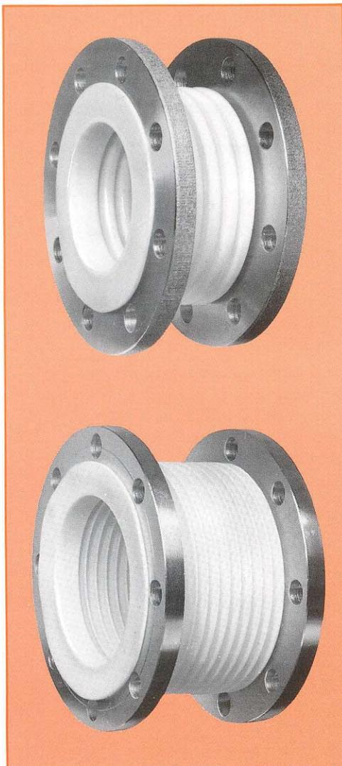
Os foles das juntas de expansão de PTFE DINAFLON, modelos DSU e DSV, são obtidos por usinagem de buchas sinterizadas de PTFE puro. Conseqüentemente apresentam a grande vantagem de se poder modificar as características geométricas das corrugações do fole (espessura, passo, altura) assim como do seu comprimento de instalação, quando necessário, de forma a satisfazer requisitos operacionais específicos.
